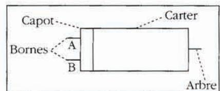
– La partie extérieure – *le stator* – comporte le carter et deux aimants permanents. Elle assure une fonction statique de maintien.
