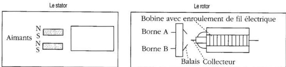
L'observation du système interne permet de formuler autrement le problème : pourquoi le moteur tourne-t-il lorsque les bornes du moteur sont en contact avec les pôles de la pile ?
